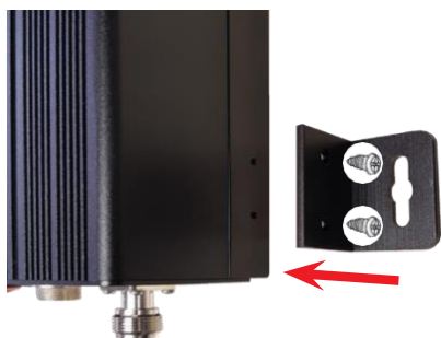
Fissare le 4 piastrine ad "L" ai lati dell'amplificatore con le apposite viti.
